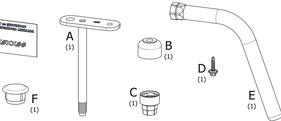
**1. BAJAR LA RUEDA Y RETIRAR EL TORNILLO QUE SUJETA LA PARRILLA PORTA RUEDA AL VEHÍCULO. COLOCAR EL SOPORTE "A" DE MODO QUE EL TORNILLO QUÉDE HACIA LA PARTE TRASERA DEL VEHÍCULO Y SUJETAR AL MISMO JUNTO CON LA PARRILLA CON EL TORNILLO ORIGINAL Y EL TORNILLO AUTOPERFORANTE "D"**
