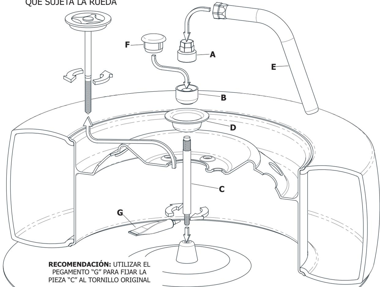
**RECOMENDACIÓN:** UTILIZAR EL PEGAMENTO "G" PARA FIJAR LA PIEZA "C" AL TORNILLO ORIGINAL
