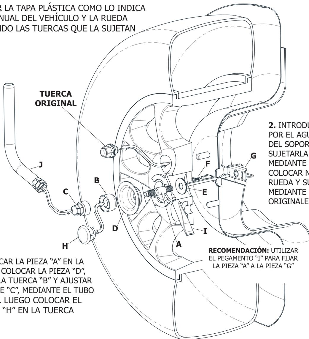
**3. ENROSCAR LA PIEZA "A" EN LA PIEZA "G", COLOCAR LA PIEZA "D", ENROSCAR LA TUERCA "B" Y AJUSTAR CON LA LLAVE "C", MEDIANTE EL TUBO LLAVE "J". LUEGO COLOCAR EL TAPÓN "H" EN LA TUERCA**
