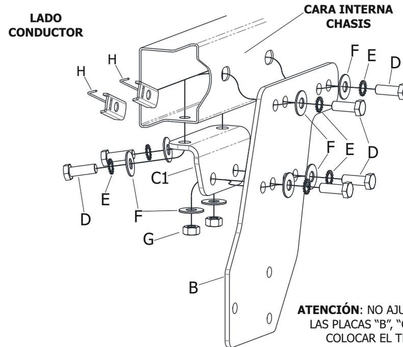
**ATENCIÓN:** NO AJUSTAR TOTALMENTE LAS PLACAS "B", "C1" Y "C2" HASTA COLOCAR EL TRAVESAÑO "A"
