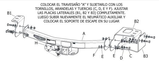
4. COLOCACIÓN DE PIEZA "A", "B3" Y "H"
