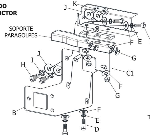
RETIRAR LOS TORNILLOS QUE SUJETAN EL SOPORTE DEL PARAGOLPES, INTERCALAR LA PIEZA "C1" Y COLOCAR LA PLACA LATERAL "B" SUJETANDO AMBOS AL CHASIS Y ENTRE SI CON LOS TORNILLOS, ARANDELAS Y TUERCAS SUMINISTRADAS
