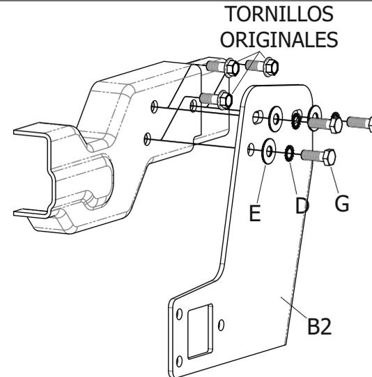
RETIRAR LOS TORNILLOS ORIGINALES QUE SUJETAN EL SOPORTE DEL PARAGOLPES, COLOCAR LAS PLACAS LATERALES (B1 Y B2) Y SUJETAR CON LOS TORNILLOS Y LAS ARANDELAS PROVISTAS (G, D Y E), SIN AJUSTAR TOTALMENTE HASTA COLOCAR EL TRAVESAÑO (A)
