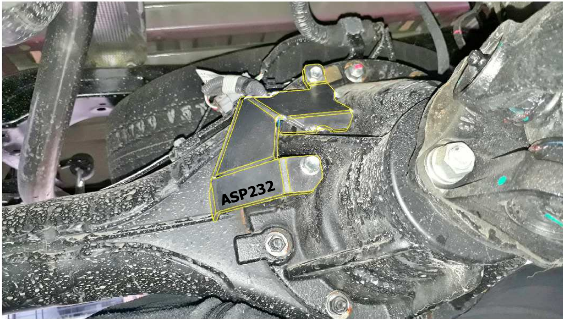
VISTA DEL VEHÍCULO INFERIOR TRASERA LADO ACOMPAÑANTE (DIFERENCIAL TRASERO)
