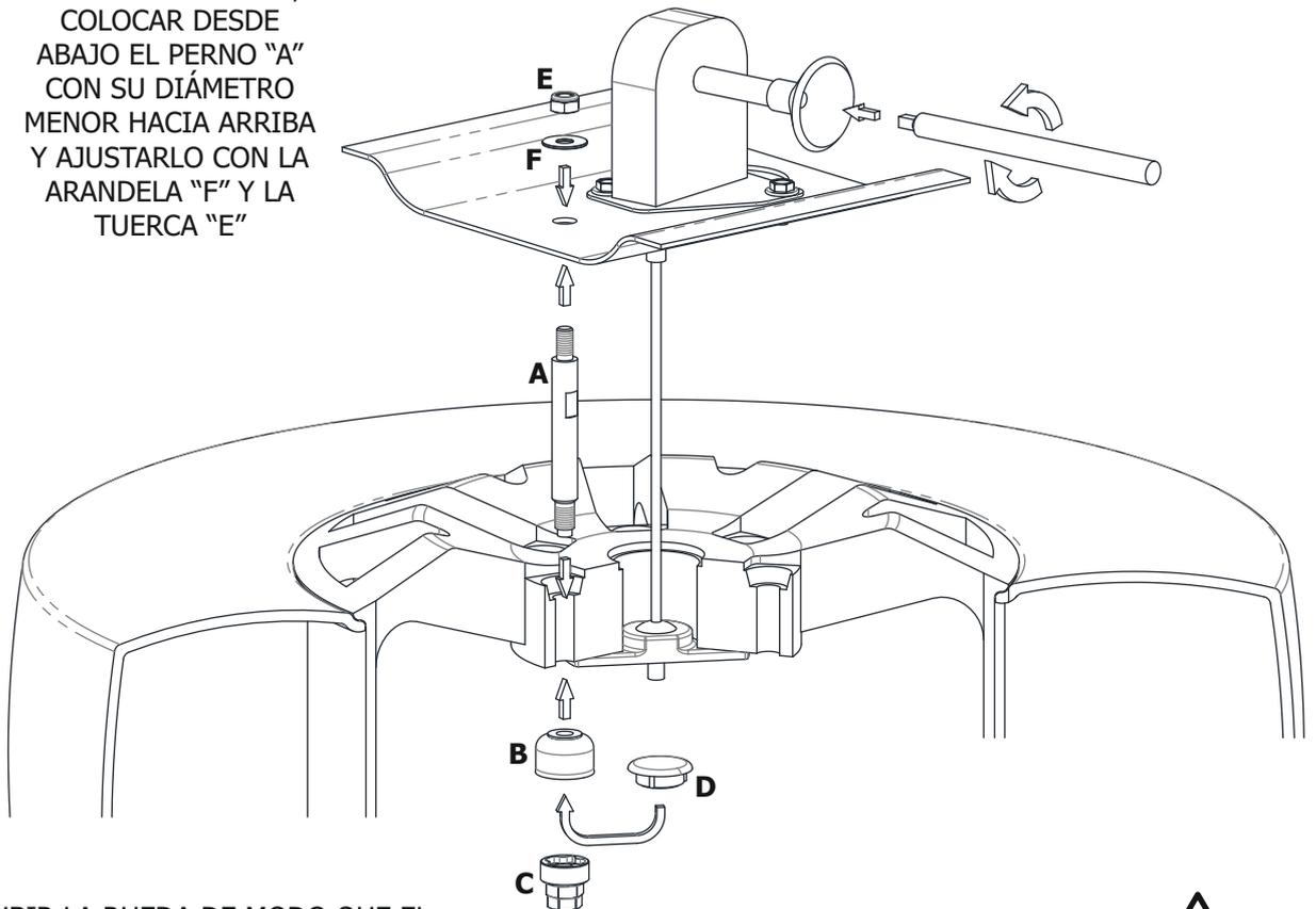
**2. SUBIR LA RUEDA DE MODO QUE EL PERNO "A" COINCIDA CON UNO DE LOS AGUJEROS DE LA LLANTA Y ENROSCAR DESDE ABAJO LA TUERCA "B" Y AJUSTARLA CON LA LLAVE "C". LUEGO COLOCAR EL TAPÓN "D" EN LA TUERCA**
