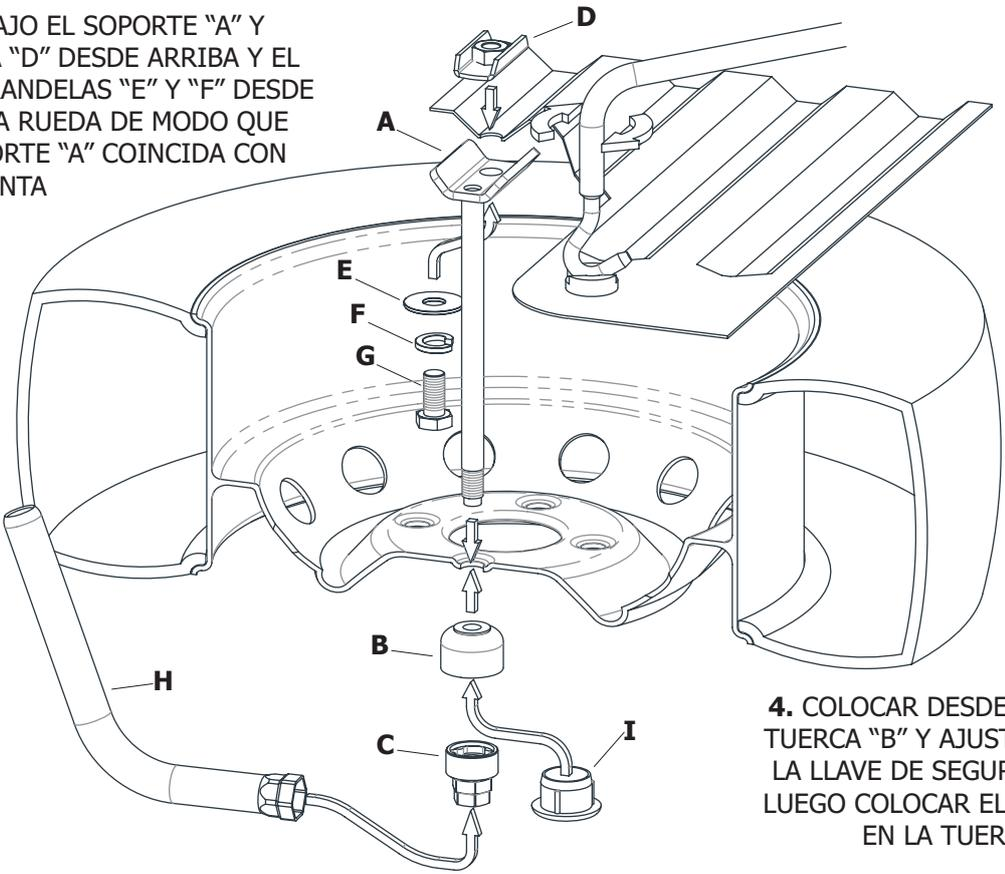
4. COLOCAR DESDE ABAJO LA TUERCA "B" Y AJUSTARLA CON LA LLAVE DE SEGURIDAD "C". LUEGO COLOCAR EL TAPÓN "I" EN LA TUERCA
